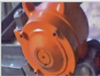
VIBROTOR™ CCR 5500 consolidando elementos prefabricados de hormigon.
