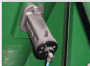
Vibradores de Impacto de Intervalo 135 en cono.
