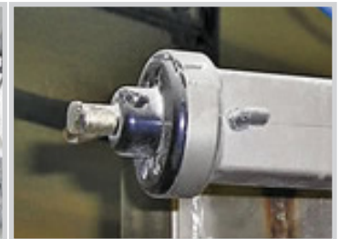
Vibradores de Impacto de Intervalo 135 en Tubo.
