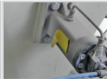
Vibradores de Impacto de intervalo 150 en tolva.
